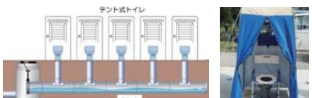
大地震がくると下水道も使えなくなり、トイレが使えなくなります。その時は、地下にタンクがあるテント式トイレを使います。
